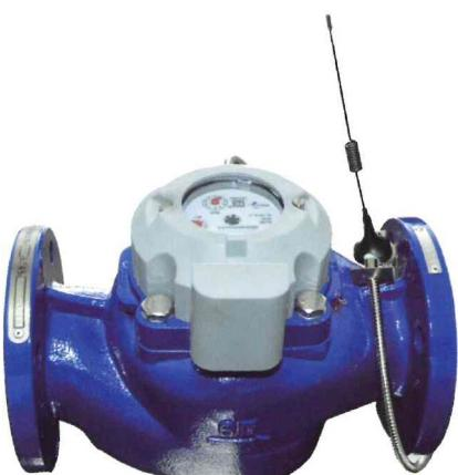
垂直螺翼式水表，主要用于计量流经管道的水体总量。水表属无蜗杆齿轮传动机构，叶轮直接驱动计数器，传动效率高，始动流量低、量程宽、测量精度高。可拆式计量机芯结构，方便维护，读数直观、清晰。通过配置有线或无线远传通讯装置，既适合人工抄表，也适合实时监控、远程抄表的现代化管理的需求。设计科学，技术先进，代替人工抄表，更方便，更快捷，抄表成功率高。
