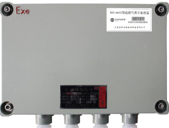
KE-6603智能燃气表采集装置是一种用于工商业大用户的燃气表远程自动抄表设备，由集中器、断路器、防雷模块、防爆箱及配件等组成。装置通过RS485等现场总线方式实时抄读燃气表数据，通过以太网、2G/3G/4G、NB-IOT等方式与燃气公司管理主站交换数据，最多可支持192块燃气表数据的抄读，可支持多种燃气表通信协议，采集数据主要包括累积流量、瞬时流量、温度、压力、剩余气量等。通信协议、采集数据项、燃气表个数等可以根据需求进行定制。
