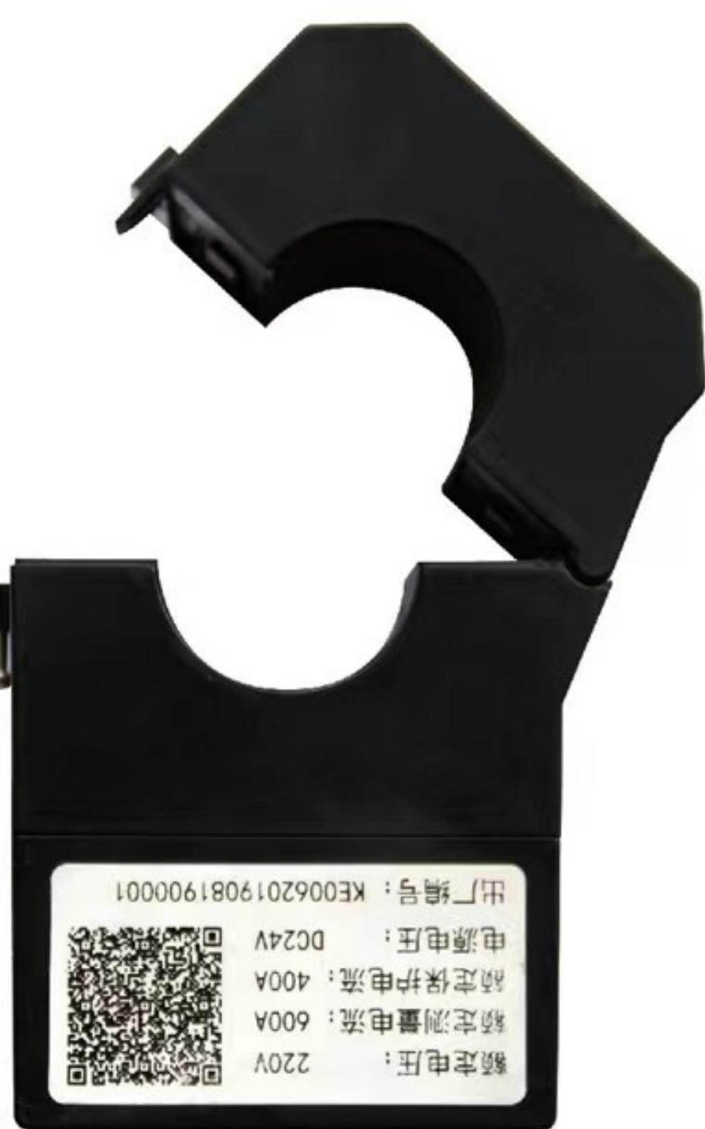
KE-6655 低压分路监测单元主要安装于开闭所、配变室的低压出线、分支箱、用户表箱，适用于400V 电量监测和故障监测。可采集低压线路上的运行电流、电压,计算线路有无功，与智能融合终端或智能配变终端配合实现集配电台区供电信息采集、设备状态监测及通讯组网、就地化分析决策、主站通信及协同计算等功能于一体的二次设备，实现电网网络拓扑、故障点分析及预测，从而实现电网二次侧的主动智能运维。
